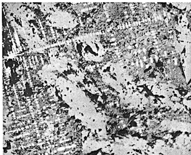
Fig. 10 — New Weir forge slag (X 130)
