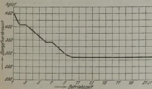
Abbildung 2. Stündlicher Dampfverbrauch. Einsatz: 24,92 t Sand, 30,07 t Eisen.
