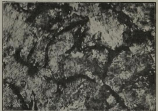
Abbildung 9. Schmelze 42 (ungeheizt). 3,26 % C, 0,78 % geb. C, 1,57 % Si, 0,85 % Mn, 0,44 % P, 0,08 % S; geätzt mit alkoholischer Pikrinsäure.
