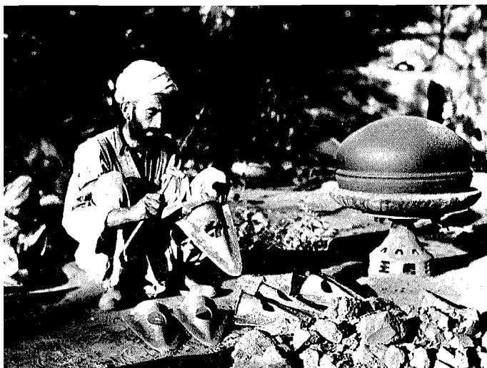
Abb. 16. Rechts im Bild der fertige Kern für den Kochkessel auf Formteller und Formscheibe. Die glatte, geschwärzte Oberfläche der Form ist deutlich. Im Vordergrund fertig gegossene Pflugscharen, die aus den Formen gelöst sind und gesäubert werden
