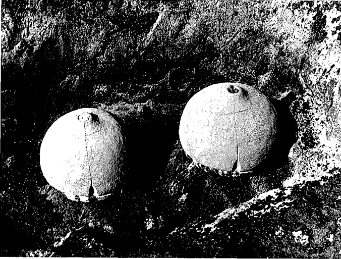
Abb. 18. Fertige Form für Kochkessel. Man erkennt die drei Schalenteile, die Griffkerben an den Basen und die Eingüßlöcher an der Spitze
