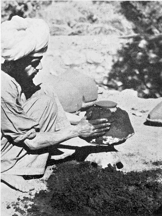
Abb. 12. Der Gießler beim Formen: Auf der gußeisernen Formscheibe liegt der tönernerne Formsteller mit dem fertigen Kern einer Form. Der Gießler ist dabei, die Außenform aus Formsand frei aufzubauen
