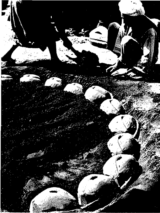
Abb. 21. Der Herd wird vorbereitet. Im ausgehobenen Graben sitzen die fertigen Formen. Sie werden mit Altsand angedeckt
