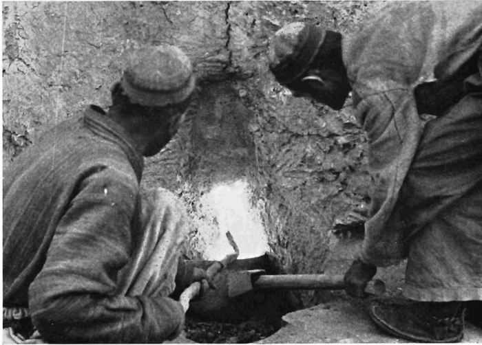
Abb. 22. Der Abstich. Der Gießer mit der Gießpfanne und – sein Bruder mit einem Stock vor dem Ofen
