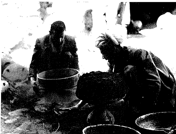
Abb. 14. Beim Aufbau der Form für den Koehkessel: Form- teller und Formscheibe sind deutlich. Im Hintergrund links wird Sand für die Schwärze gesiebt
