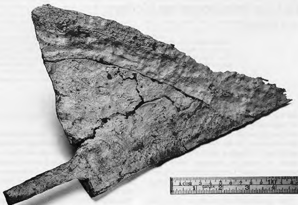
Fig. 1. Plovskær fra Alrø, Horsens Fjord, 1400-tallet. Vægt 1,9 kg. Plovskæret er bygget op ved essesvejsning af tre stykker jern. Arhundreders korrosion har delvist løsnet stykkerne fra hinanden, således som det ses her, hvor rustskorperne er blevet fjernet ved sandblæsning.
