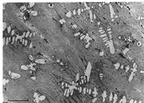
Fig. 9. Poleret snit gennem slagge i kloten Karup II. Slaggen er størknet til et eutektikum af fine wüstitdendritter (hvide) og lange, smalle fayalitbjælker (grå). Den glasagtige, sidst størknende matrix (sort) udgør kun en beskedne del. Målestok 50µm.
