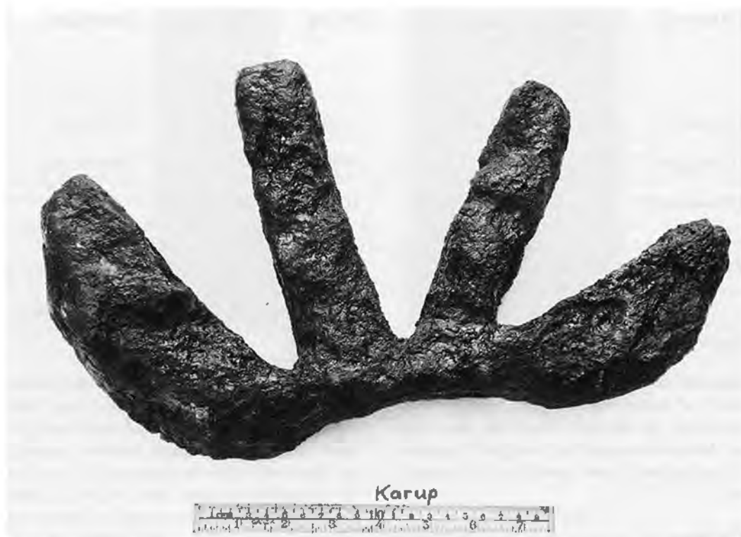
Fig. 7. Firedelt klode, fundet i Karup Å, nu i Vejle Museum (Karup I, nr. 964x1). Med et rumfang på 1,9 l og en vægt på kun 8,2 kg er vægtfylden kun 4,3. Før korrosionen satte ind, må kloden have bestået af ca. 45 vol% jern, 45 vol% slagge og 10% porer. Den må have vejlet ca. 10,2 kg og have haft en vægtfylde på ca. 5,4 g/cm 3 .
